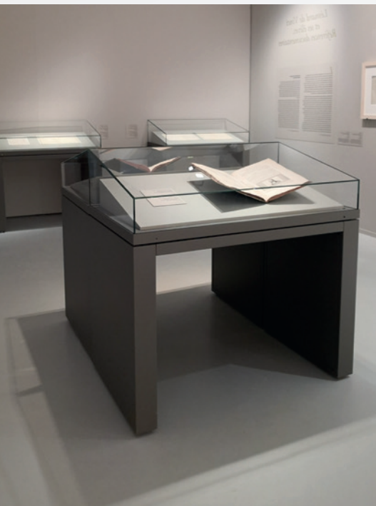
Vitrines régulées par contrôle hygrométrique passif au Château du Clos-Lucé
