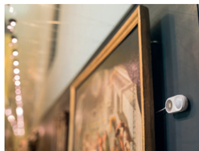
Enregistreur 160 E avec sonde déportée Lux et U.V.
