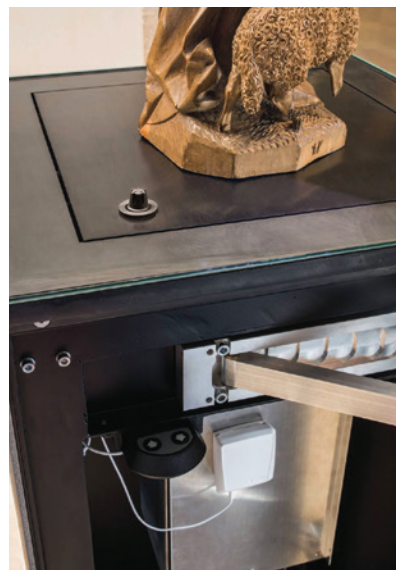
Enregistreur 160 E avec sonde déportée spéciale vitrine
