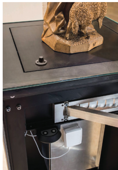
Enregistreur 160 E avec sonde déportée spéciale vitrine
