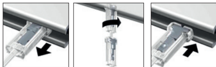
D - Le fil perlon équipé du Cliq2fix empêche toute sortie du rail en cas de déplacement brusque. Il est particulièrement recommandé pour les rails plafond.
