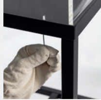
Sécurisation de la cloche après avoir positionné les objets
