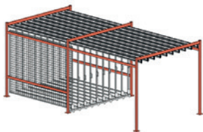
Montage au sol avec structure autoportante
